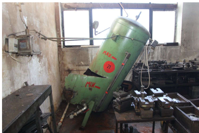
Obrázek č. 25 - Roztržená tlaková nádoba s následkem vznikem PÚ
