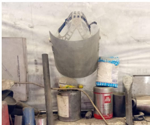
Obrázek č. 7 - Silně znečištěný ochranný štít
