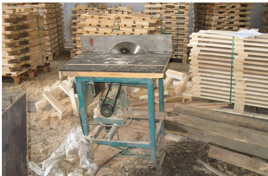
Obrázek č. 6 - Kotoučová pila bez ochranných krytů
