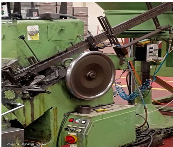
Obrázek č. 11 - Chybějící nebo nefunkční kryty u stroje
