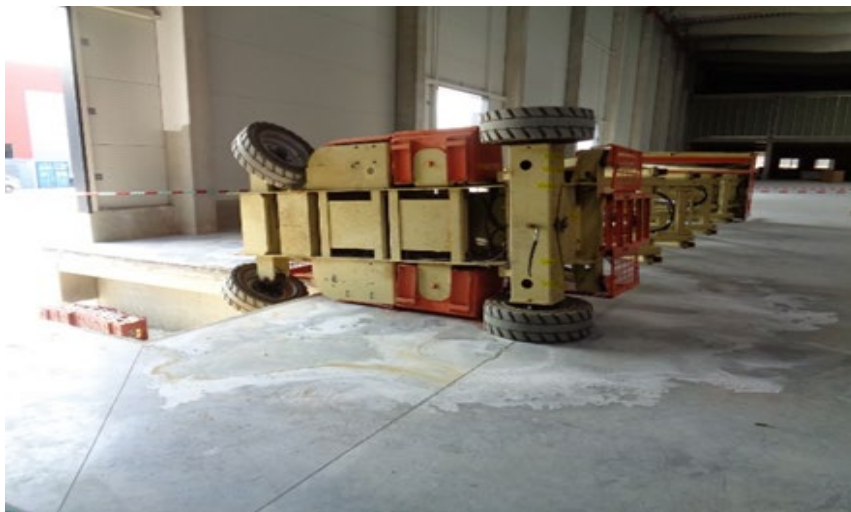
Obrázek č. 18 - Najetí pojízdné zdvihací pracovní plošiny na hranu nájezdové rampy s následným převrácením
